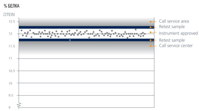
Проверенная стабильность инструмента за 100 дней работы без регулировки.
